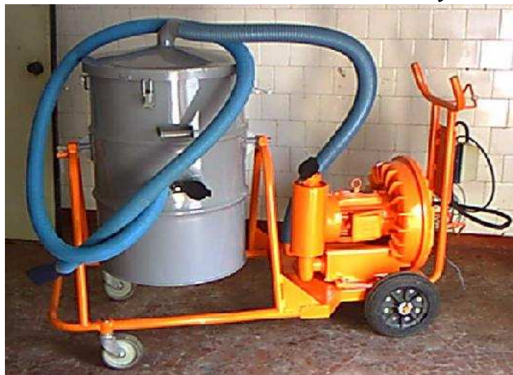
MODELO CICLONE EH-200 LITROS TRIFÁSICO 220V : 7,5 CV.
