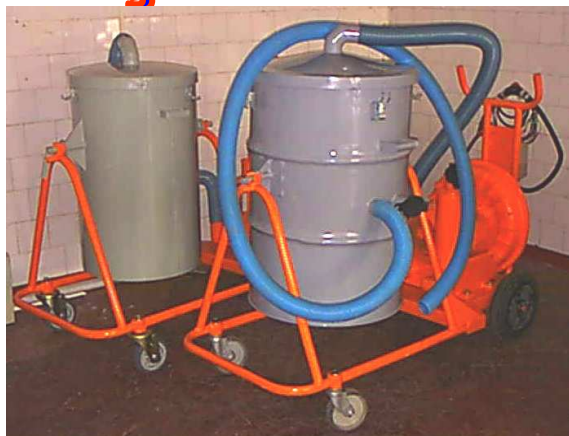
MODELO CICLONE EH-200 LITROS TRIFÁSICO 220V : 7,5 CV.
